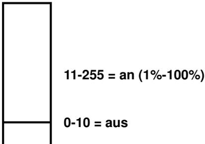
**Zwischen den Werten 0 und 10 von Steuerkanal A ist die Maschine aus.**
